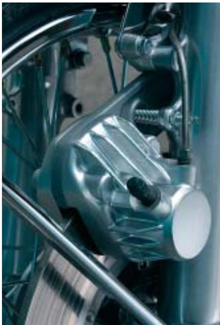
*Una delle caratteristiche salienti di questa moto era l'adozione di un freno a disco anteriore di diametro 296 mm, frenato da una pinza a singola azione (in alto) montata su un braccio oscillante infulcrato sul fodero della forcella con funzione autoallineante.*
