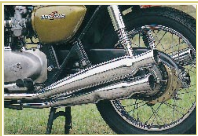
La ruota posteriore con il tamburo di 180 mm di diametro e che restò immutato per tutta la produzione. Gli ammortizzatori regolabili non erano un portento e venivano spesso sostituiti con prodotti nazionali, superiori come idraulica e con le molle più rigide.
