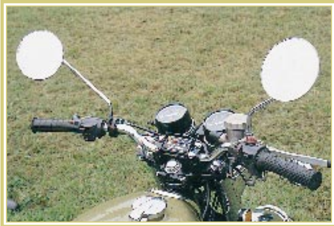
Il comandi al manubrio sono di eccellente fattura. Gli strumenti Denso sormontano il piccolo cruscotto portaspie, introdotto per primo sulla 500 e adottato poi sulla 750 con la serie K2 del 1972.
