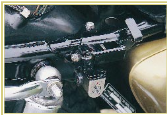
La serratura di chiusura della prima versione ha un meccanismo diverso da quello delle successive, dotate del solo scatto.
