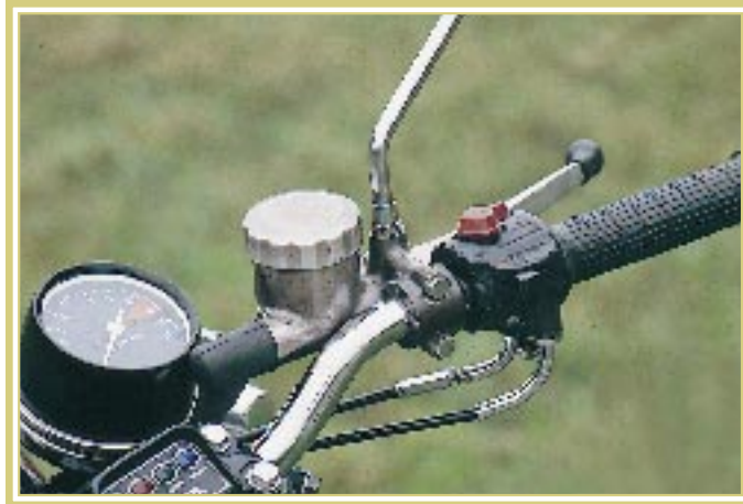
La pompa idraulica per il comando del freno anteriore. Oggi è la norma, ma 30 anni fa era una novità. Notare il doppio cavo di comando dell'acceleratore: uno per l'apertura l'altro per la chiusura.
