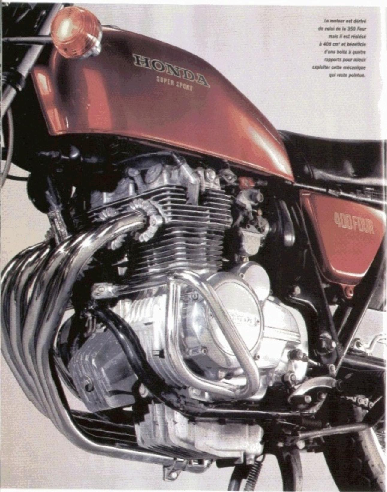
Le moteur est dérivé de celui de la 350 Four mais il est réalisé à 408 cm<sup>3</sup> et bénéficie d'une boîte à quatre rapports pour mieux exploiter cette mécanique qui reste pointue.
